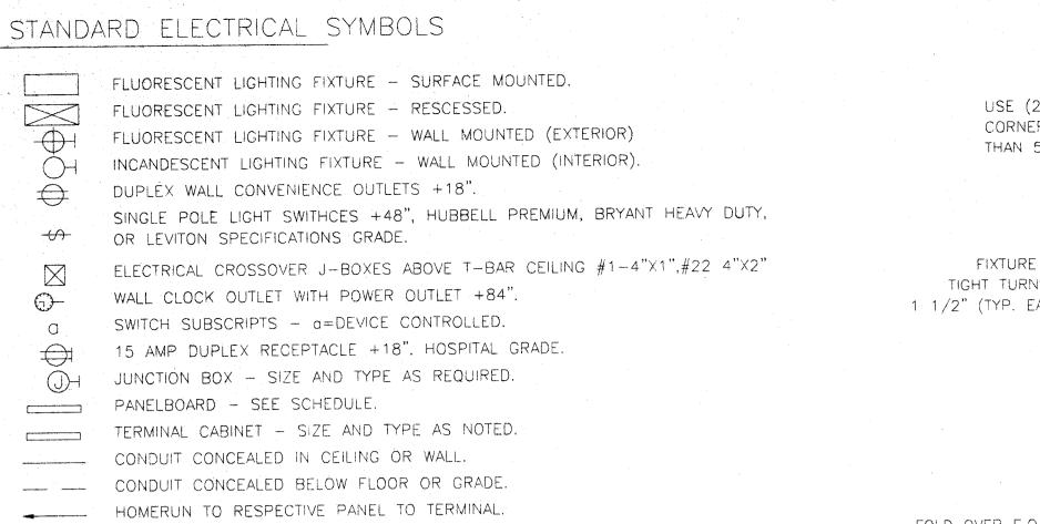
BRANCH CIRCUIT WITHOUT FURTHER DESIGNATION IS A 2#14 WIRE NOTE CIRCUIT, FOR MORE THAN 2#14 WIRES AS FOLLOWS, -11-3#14, -++++-4 4#14 ETC. FOR OTHER SIZES AS FOLLOWS, -+++- 3#10, -++++ 6 ETC.
