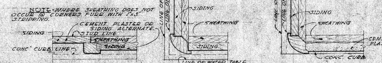
TYPICAL JUNCTION OF CORNER-BEAD SIDING ON STUDS & SHEATHING FOR SIDING & PLASTER
